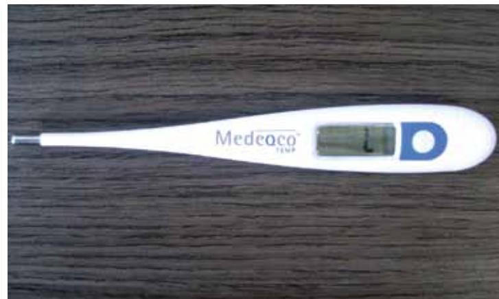
Termômetro digital (Geratherm) que substituíram os termômetros de mercúrio
